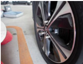
①ハブ側にナットアダプターを取り付けます。
