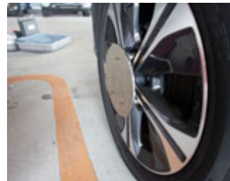
②マグネットホルダーを取り付けたベースプレートをハブ側へ吸着させます。
