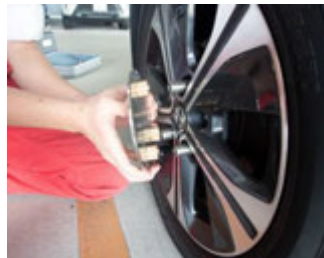
②マグネットホルダーを取り付けたベースプレートをハブ側へ吸着させます。
