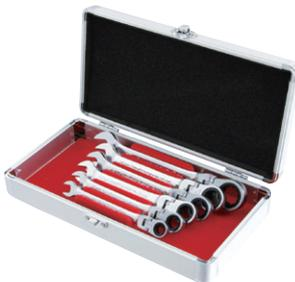
ギア数72山、送り角5度のギアにフレックス機構を採用した高効率ギアレンチ。フレックス機構は180度首振りOKで、12段階15度の角度調整で固定できるロック機構を採用しているためハンドルの振りが制限される狭いエンジンルーム内でも機能性は抜群です。また特殊な構造によりギアが滑らず、本締め作業が可能です。
